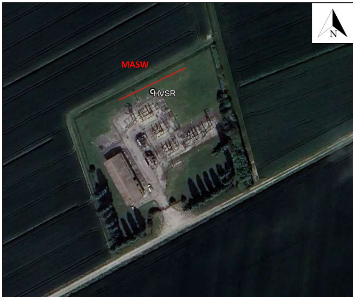
Figura 2 - Ubicazione della prova MASW, indicata dalla linea rossa, e della prova HVSr, indicata dal cerchio bianco, presso la cabina primaria dell'Enel a Tresigallo (FE)
