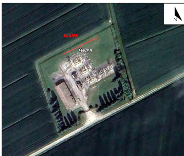
figura 21: ubicazione prove sismiche (linea rossa = MASW - punto bianco = test HVSR)
