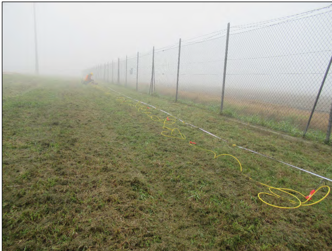
Figura 6 - Strumentazione utilizzata per l'indagine MASW
